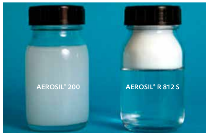
Abbildung 6 Verhalten von AEROSIL® 200 und AEROSIL® R 812 S gegenüber Wasser. Während AEROSIL® 200 sich leicht in Wasser dispergieren lässt, wird AEROSIL® R 812 S von Wasser nicht benetzt und schwimmt auf der Wasseroberfläche.
