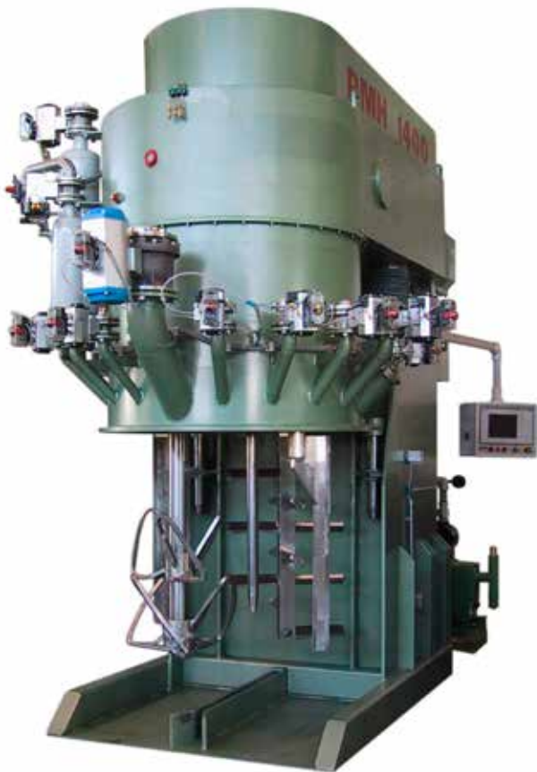
Abbildung 7 LSR-Planetendissolver im Produktionsmaßstab, 1400 l, Fa. Netzsch Feinmahltechnik GmbH, Mannheim
