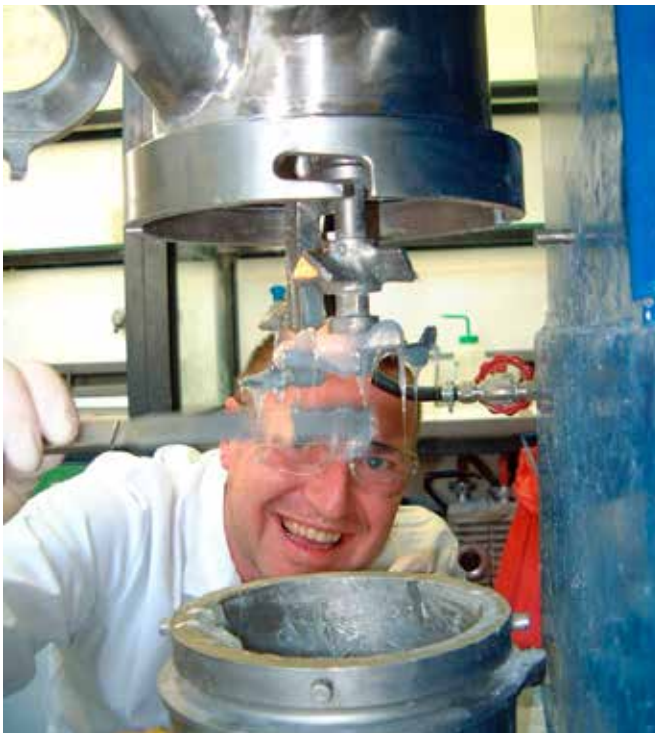
Abbildung 11 Planetendissolver; Hersteller: Hermann Linden, Marienheide, Germany
