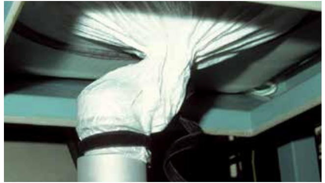
Abbildung 11 Öffnen des Auslaufstutzens
