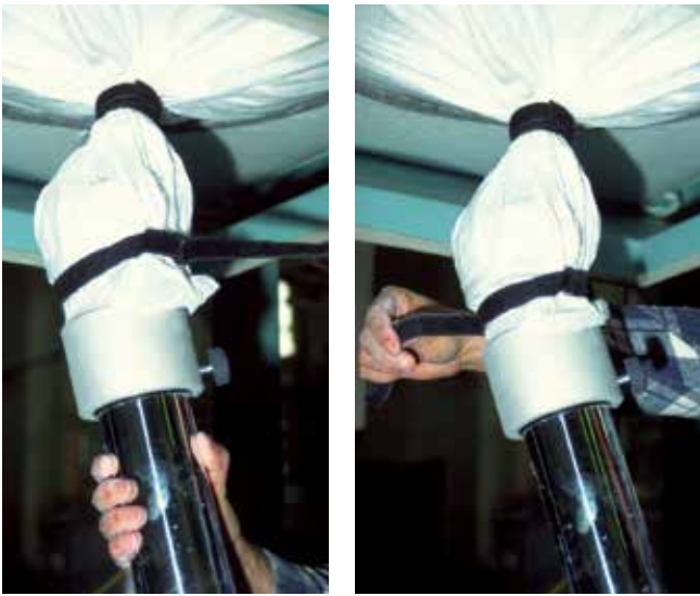
Abbildung 10 Befestigung des PESy an dem Auslaufstutzen des FIBC
