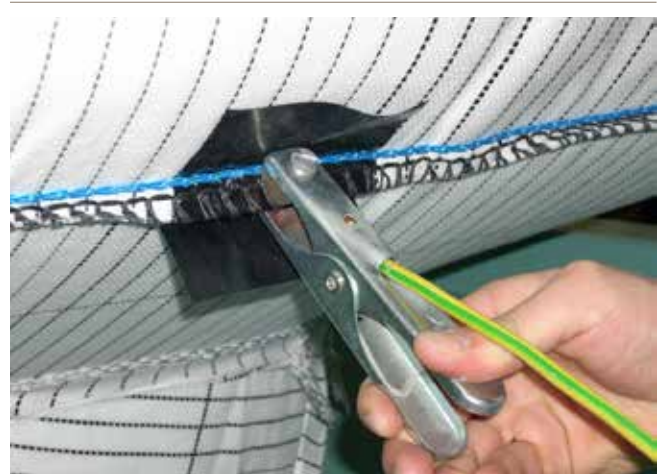
Abbildung 7 Erdung des FIBC
