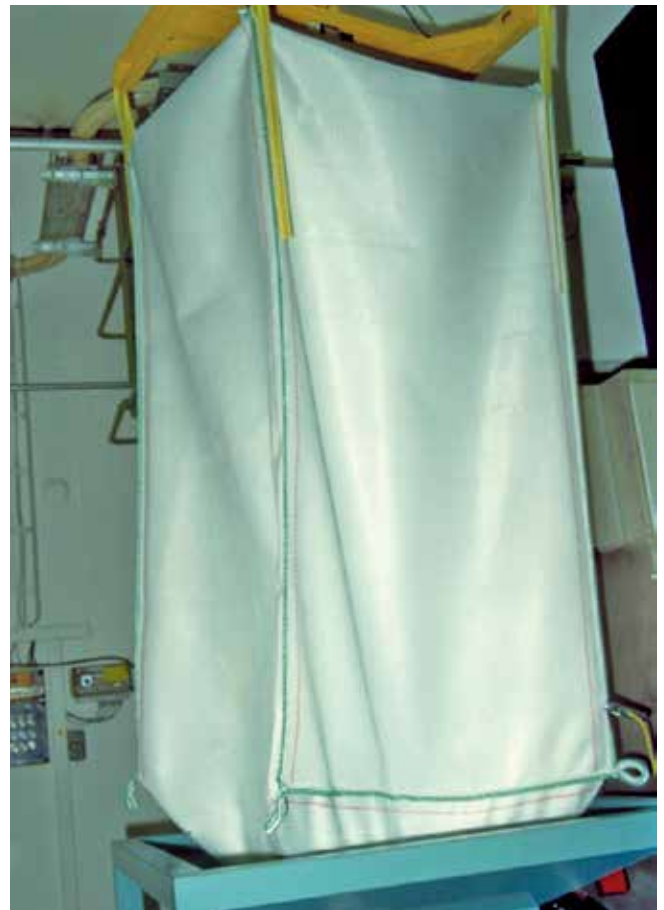
Abbildung 16 FIBC gegen Ende der Entleerung
