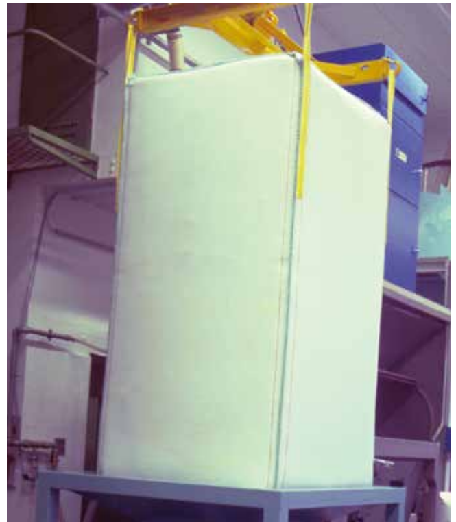
Abbildung 6 FIBC vor der Entleerung
