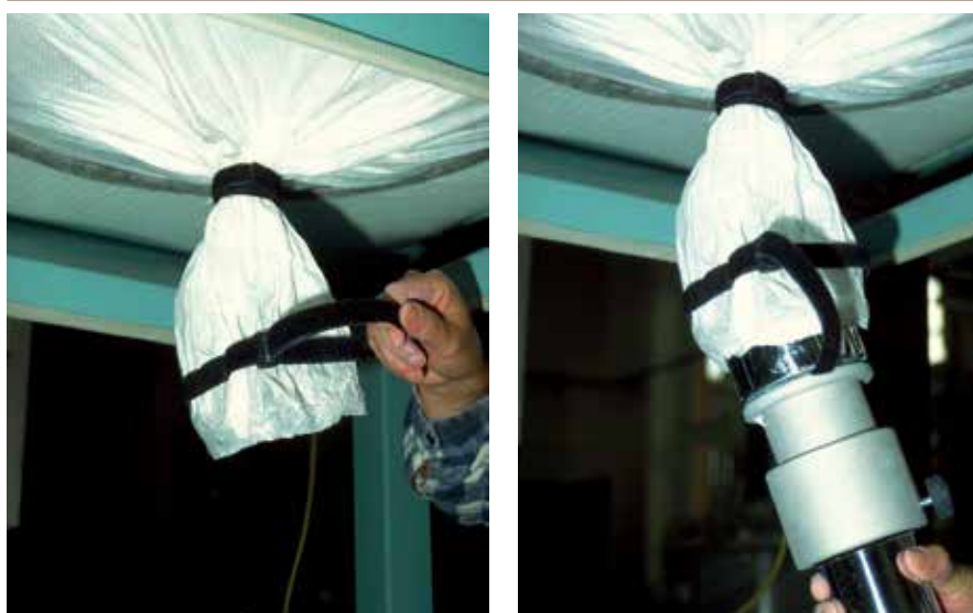
Abbildung 9 Einführen des PESy in den Auslaufstutzen
