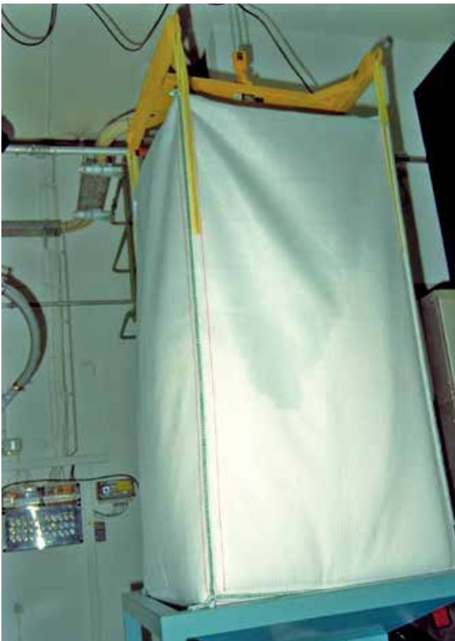
Abbildung 15 FIBC während der Entleerung
