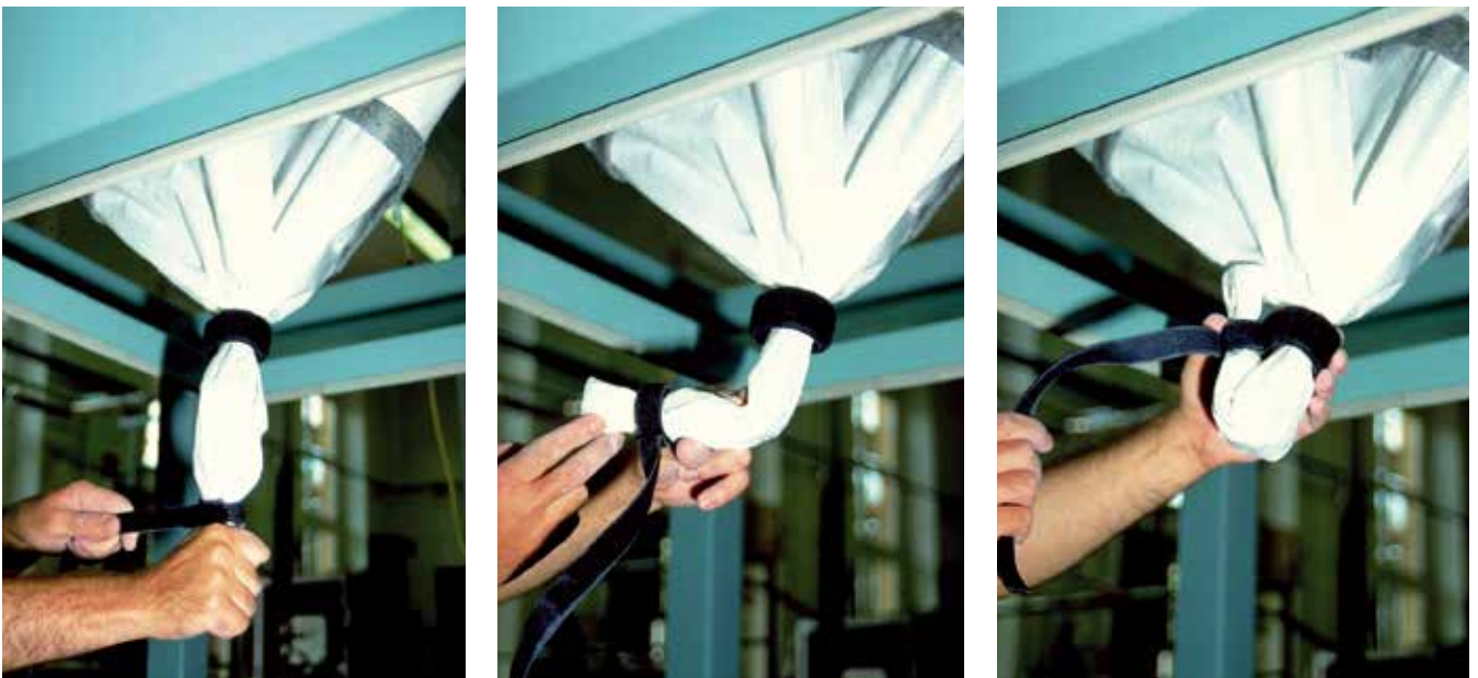
Abbildung 20 Binden des Schwanenhalses zum staubdichten Verschließen des FIBC nach der Entleerung
