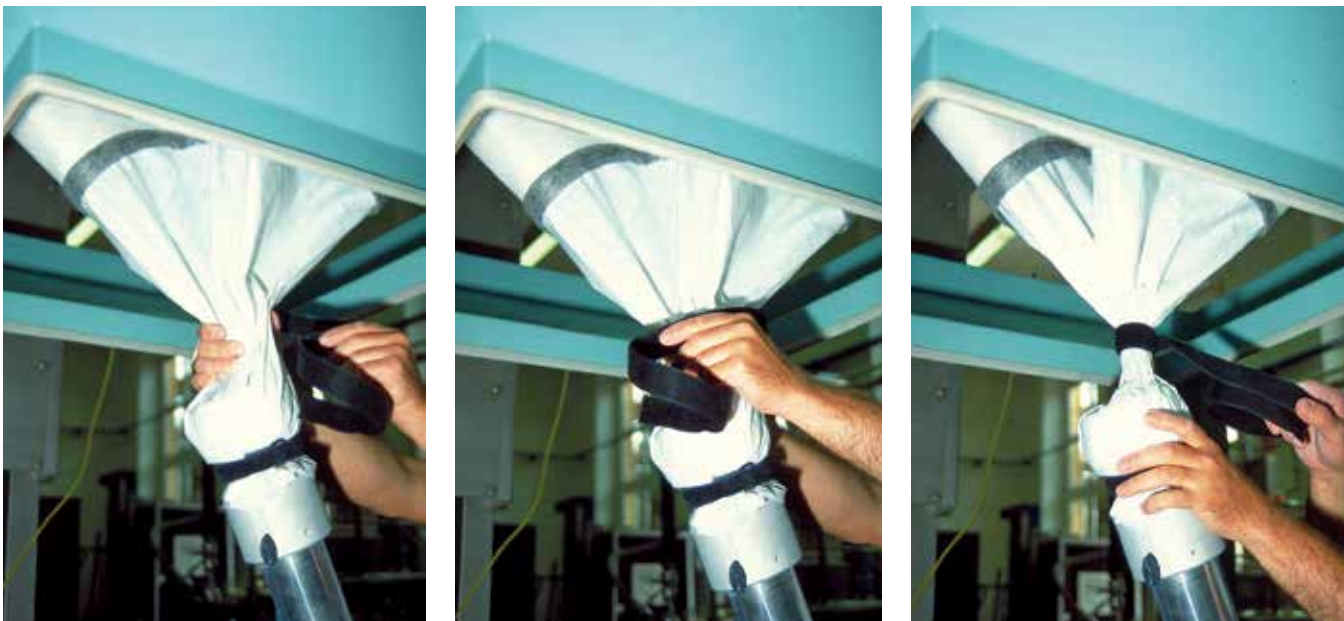
Abbildung 18 Verschließen des Auslaufstutzens
