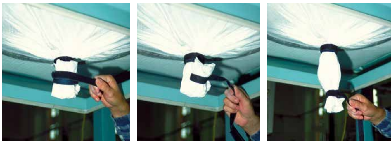
Abbildung 8 Öffnen der Schwanenhalsabbindung
