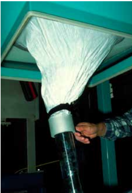
Abbildung 12 Einschieben des PESy in den FIBC
